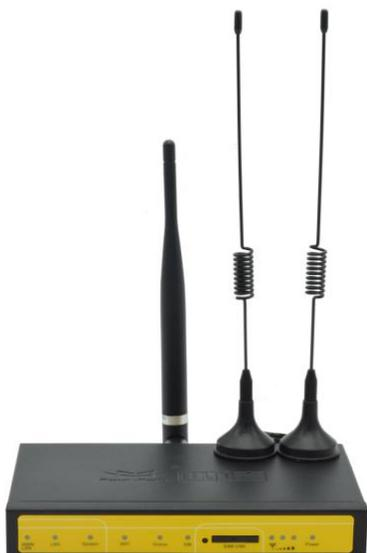
F8926-GW 基站是一种基于 LoRaWAN 协议的无线通信基站，接入各类应用节点的 LoRaWAN 终端，采集到的信息通过 3G/4G 或有线以太网方式传送到云端服务器。该产品采用高性能的工业级 32 位通信处理器和工业级无线模块，以嵌入式实时操作系统为软件支撑平台，同时提供 1 个以太网 WAN/LAN 可配置，1 个 LAN，1 个 WIFI 接口，支持 WIFI 无线配置管理和在线升级，DC 供电。
